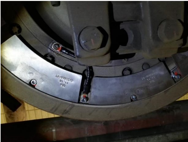
Abbildung 3: Strombrücken und Absorber im eingebauten Zustand am Aluminium Hybridrad [3]
